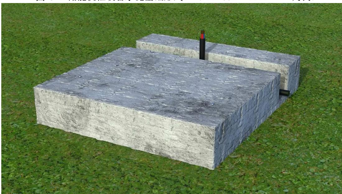
图 3-2 储能机柜设备水泥基础形式2（KYT60kW-221kWh-A为例）
