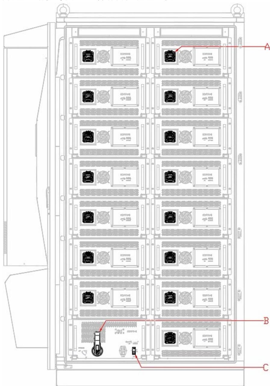
图 7-1 储能机柜操作开关位置总览（KYT60kW-221kWh-A为例）
