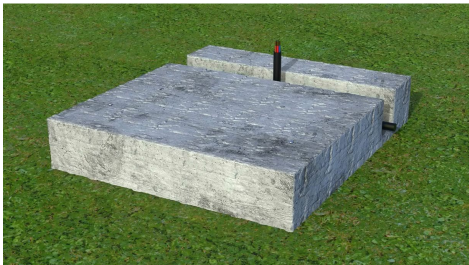
图 5-4 储能机柜设备水泥基础形式2
