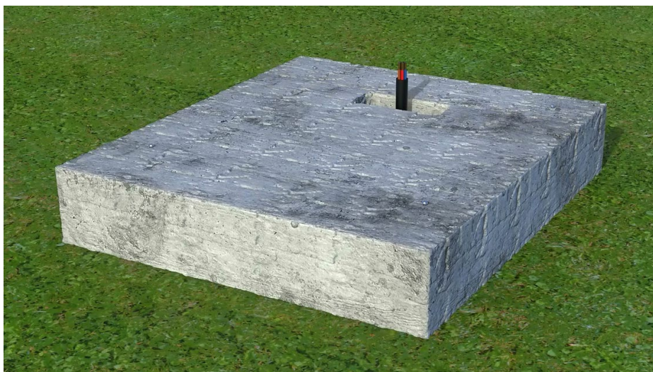
图 5-3 储能机柜设备水泥基础形式1
