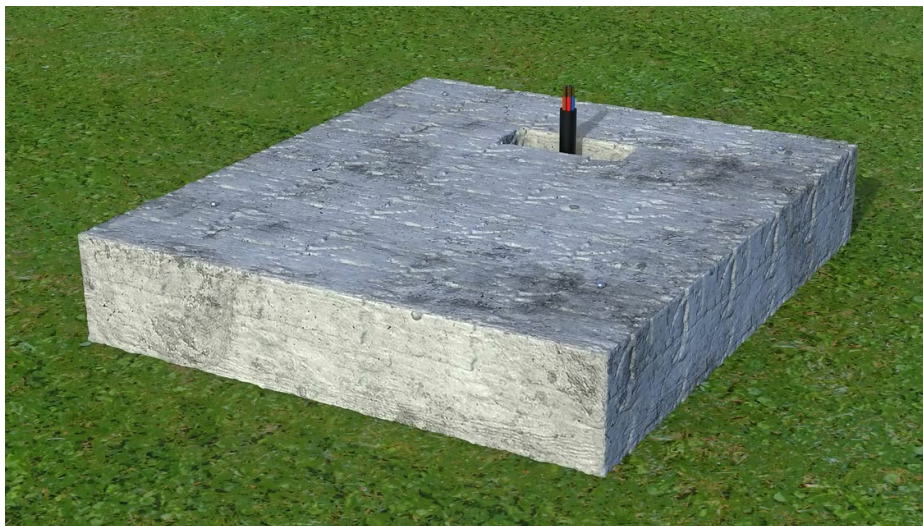
图 5-3 储能机柜设备水泥基础形式
