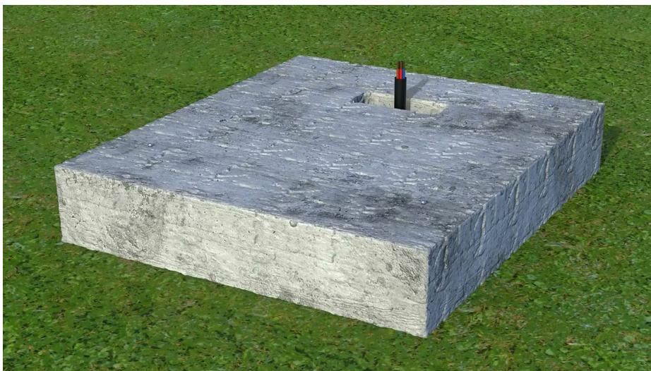
图 5-3 储能机柜设备水泥基础形式1
