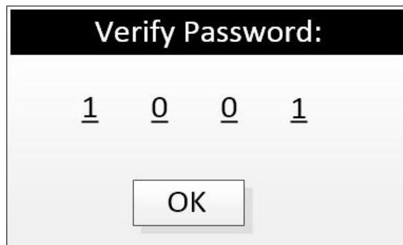
3) 在上述界面下，输入密码后，按下“ENTER”键后进入如下菜单，界面会显示当前的工作模式，按下“ENTER”键，通过“UP”，“DOWN”按键选择需要的工作模式，再次按下“ENTER”按键后确认选择的模式，移动光标至“OK”，按下“ENTER”键后确认输入。
