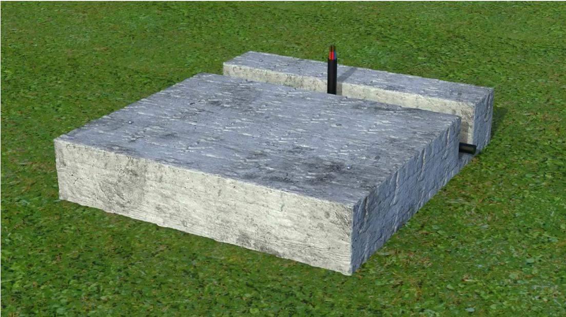
图 3-2 储能机柜设备水泥基础形式2（KYT25kW-60kWh-A为例）
