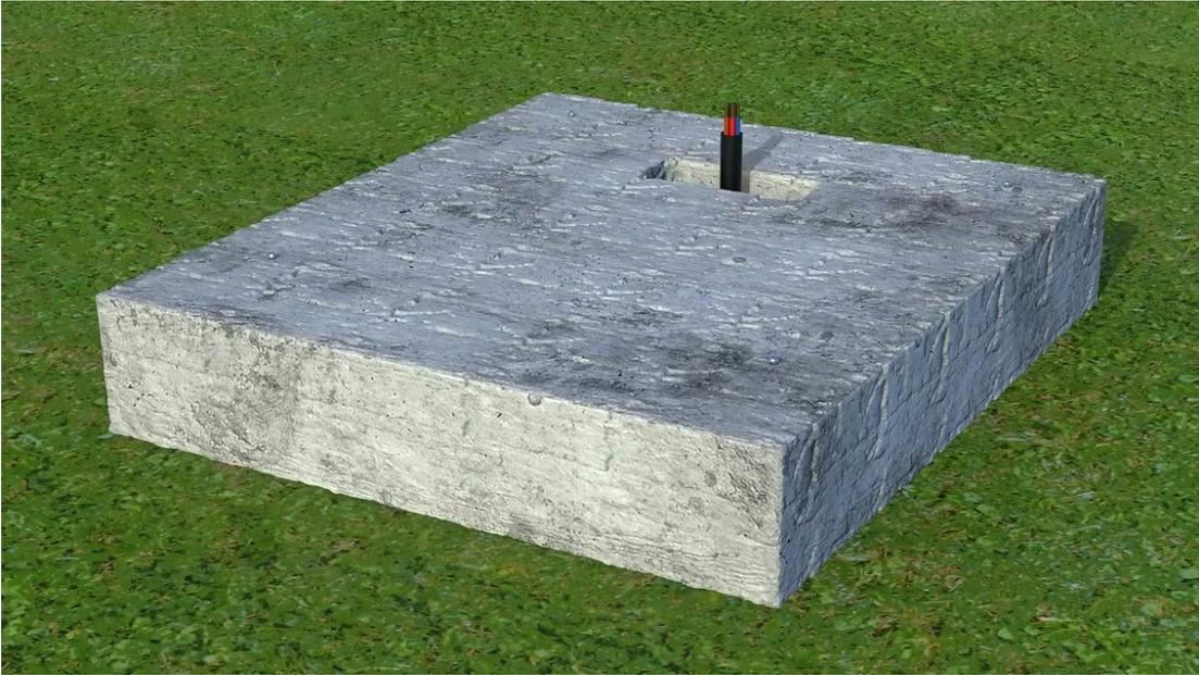
图 3-1 储能机柜设备水泥基础形式1（KYT25kW-60kWh-A为例）
